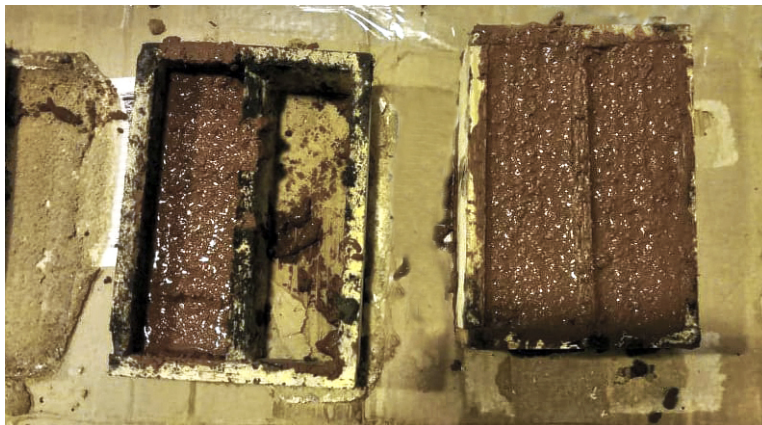
FIGURA 10B. Stampi utilizzati per far solidificare i geopolimeri. Photo by M. Franzone.
