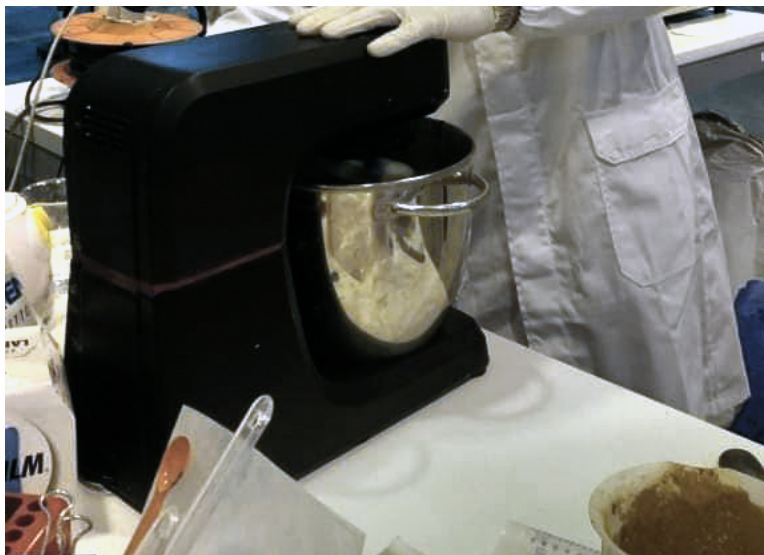
FIGURA 10A. Impastatrice utilizzata per mescolare il materiale geopolimerico. Photo by M. Franzone.
